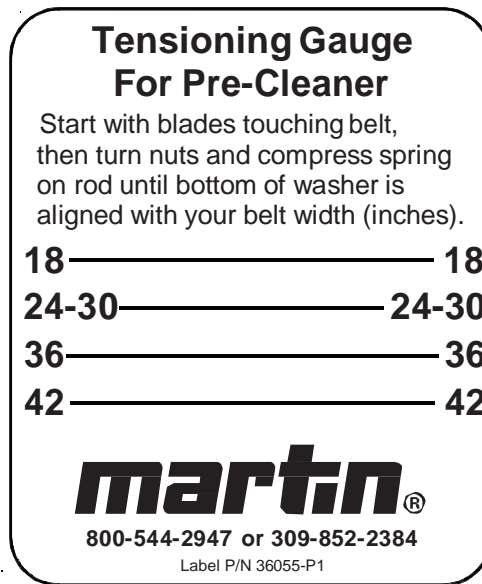
Figura 7. Etiqueta del Tensionador de Reorte Martin ® XHD (Tcurador Primario), N/P 36055-P1
