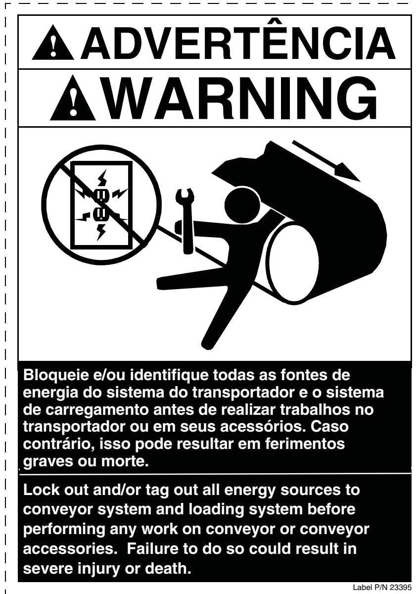
Figura 4. Etiqueta de aviso dos produtos do transportador, P/N 23395
